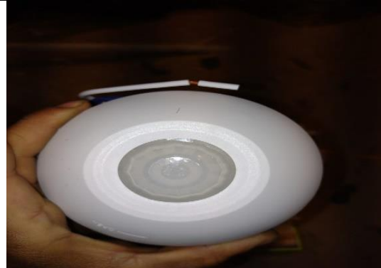
Ilustración 95 Sensores 360
